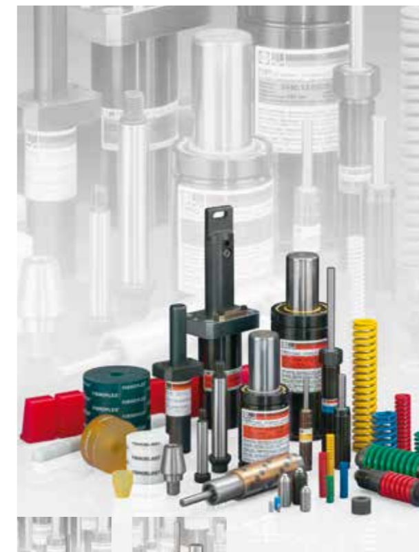
该弹簧主要应用于模具工业, 金属成型, 机床和机械工程领域; 特殊螺旋弹簧是基于 DIN ISO 10243 标准制作; 常用弹簧有蝶形弹簧、弹簧成形元件、塑料弹簧、氮气弹簧; 所有FIBRO氮气弹簧均符合欧标受压容器设备标准 97/23/EC中的规定.
