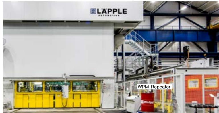
Die Empfangsreichweite des Repeaters liegt zwischen 25 - 50m. Die Befestigung des Repeaters sollte vertikal erfolgen. Eine Wandmontage ist daher einer Deckenmontage zu bevorzugen. Eine Stromversorgung und ggf. ein Netzwerkanschluss sind erforderlich.
